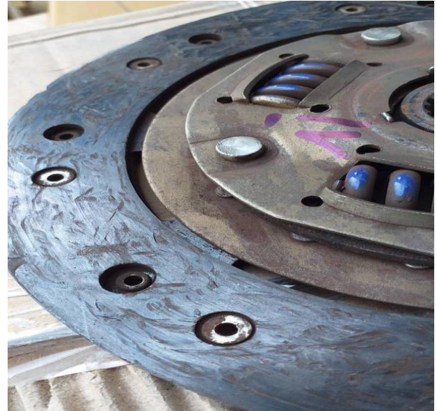
اتمام لنت صفحه کلاچ به دلیل کارکرد در کیلومتر بالا
