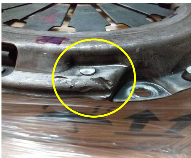
نمونه آسیب های فیزیکی به دیسک کلاچ
