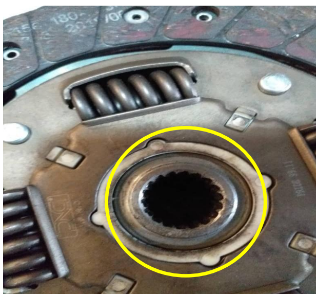
آسیب به هزار خاری به دلیل نصب نادرست و ضربه زدن هنگام نصب
