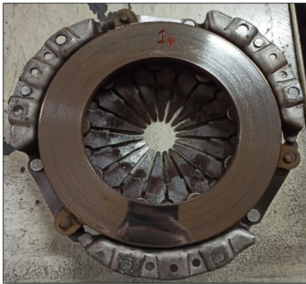
چدن دیسک کلاچ براق شده (آینه ای)
