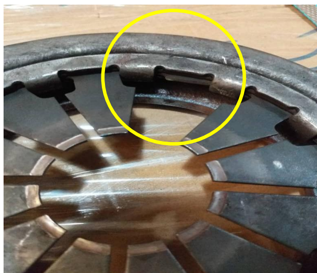
نمونه آسیب های فیزیکی به دیسک کلاچ
